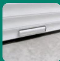
Le système de détection d'obstacle par capteur radio autorise l'écrasement du joint en partie basse **limitant les possibilités d'intrusion**. En cas d'obstacle, le capteur **détecte une vitesse de descente anormale** et libère l'obstacle en ordonnant la remontée de la porte.
