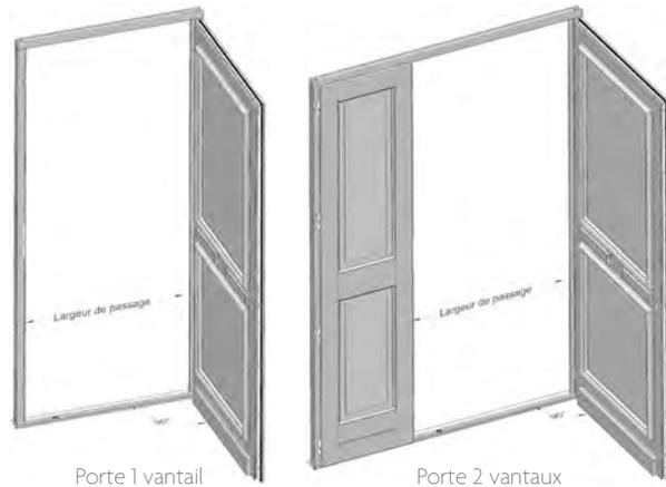
Toutes les portes d'entrée du catalogue Pasquet menuiseries sont équipées d'un seuil d'une hauteur de 20 mm. A l'exception de quelques modèles spécifiques, les portes d'entrée Pasquet peuvent être fabriquées avec une largeur de passage conforme à la réglementation sur l'accessibilité.
